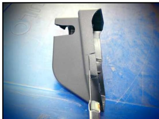
Châssis véhicule : Démontez la garniture haute.
