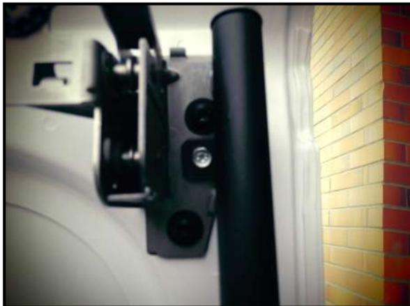
*Fixation de la partie basse* : Placer le tube suivant les cotes indiquées. Puis repérer l'emplacement de la **fixation** à l'aide d'un marqueur. Puis enlever le guide tringle haut. Percer  $\varnothing 9$ , Placer et serrer un insert M6
