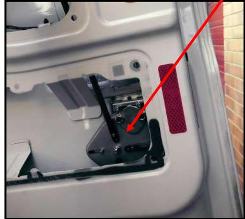
Haut de la porte : *Fixation de la partie haute* : Placer le guide tringle haut et visser avec la vis d'origine.
