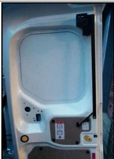
Découpe de la garniture de verrouillage haut en fonction de l'emplacement de la pate de fixation du guide tringle haut.
