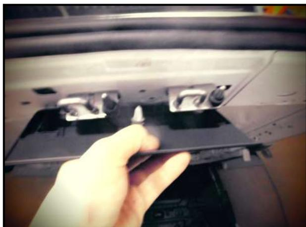
Fermer les portes, Placer la gâche haute en veillant à coïncider le trou et la tringle. Fixer avec de 4 rivets pop.
