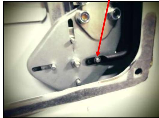
Gâche latérale : On se place sur la deuxième porte. La gâche doit coïncider avec la tringle lorsque les portes sont fermées. Tracer les deux trous, percer  $\varnothing 9$ , placer les inserts, puis fixer à l'aide de **deux vis M6**.
