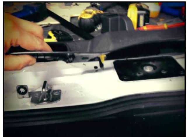
Fixer la gâche basse à l'aide de **3 rivets pop** en veillant que le trou de la gâche correspond avec **la tringle basse** lorsque la porte fermée.
