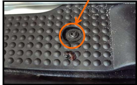
Percer le marche pied Ø11 sur l'empreinte laissée par la graisse.
