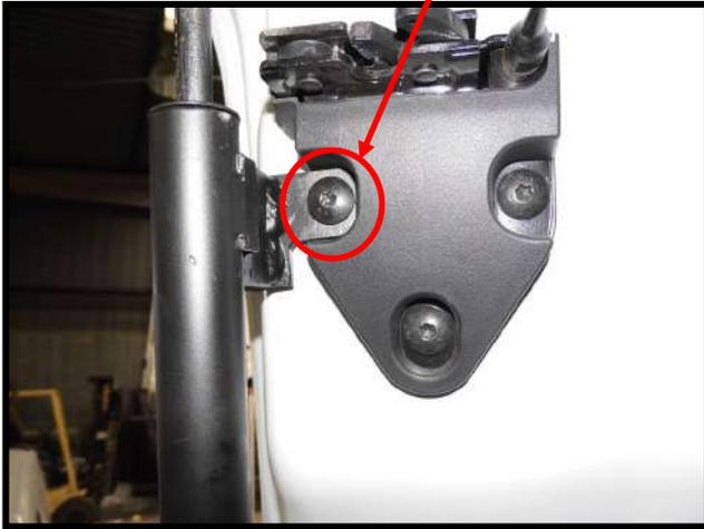
Tracer le trou de fixation bas puis retirer le guide tringle haut.
