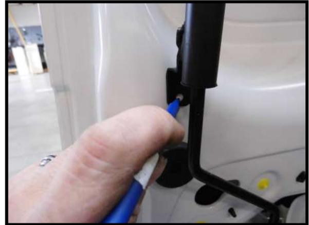
Percer  $\varnothing 9$  et placer un insert M6
