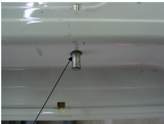
percer avec un foret de 13 et mettre un passe fils
