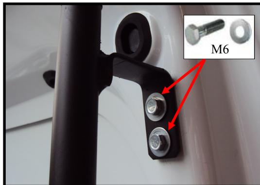
*Fixation de la partie basse: Fixer le guide tringle,.*
