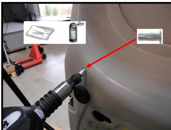
Replacer le guide tringle haut en fixant la partie haute avec les vis d'origine.
