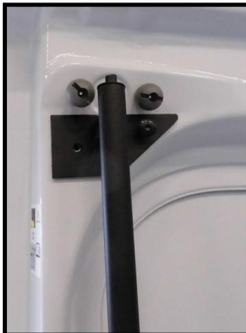
Tracer le trou de fixation bas puis retirer le guide tringle haut.
