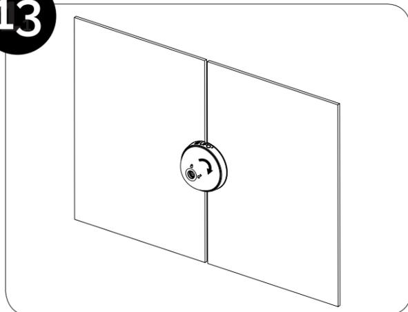
**IT** Aprire la serratura spostando la chiave nella posizione di lucchetto aperto ! **ATTENZIONE: chiudere la serratura solo con posizione di lucchetto aperto per non danneggiare la carrozzeria !**
