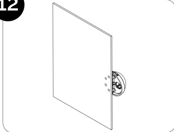
**IT** Fissare la calotta UFO² con le 4 viti M5 a testa cilindrica (coppia 2Nm)
