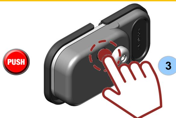
3. Appuyez sur le bouton. **LE CADENAS SE FERME** (la clé ne fonctionne pas)
