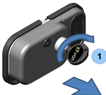
1. Insérez la clé et tournez-la d'environ 180°. En fin de rotation, la gâche (goupille) se verrouille et la clé peut être extraite en la ramenant à 0°.
