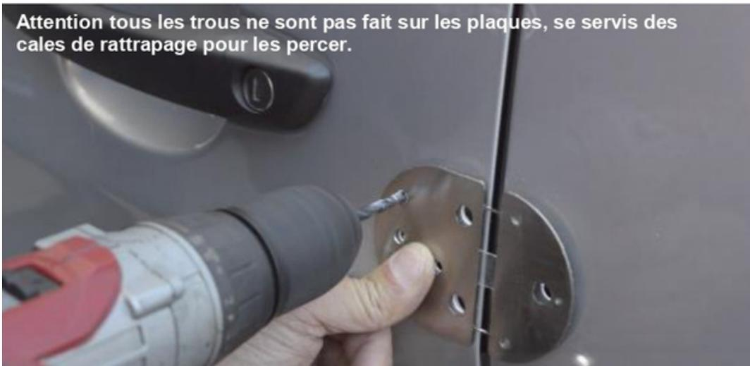
Engager les vis, les rivet puis serrer et riveter
