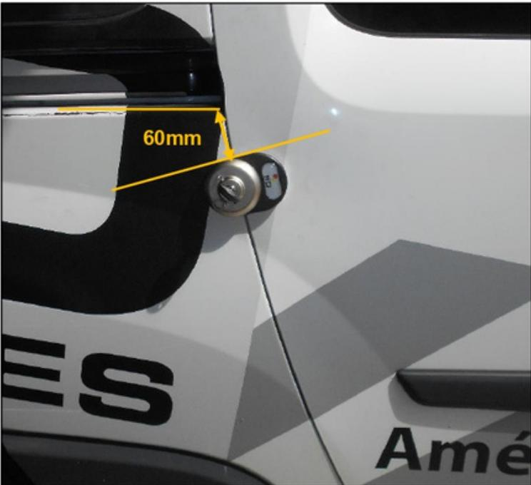
**Porte latérale: ne pas mettre en place le câble de secours si le véhicule n'est pas équipé de poignée à l'intérieur**
